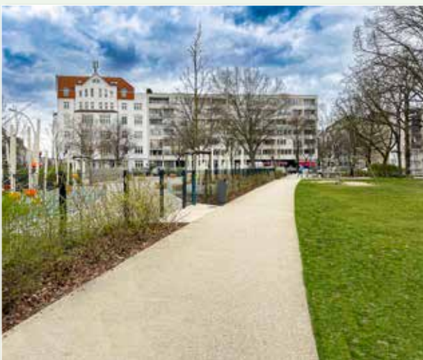
Gestaltung von Parkflächen – Olivaer Platz in Berlin vdw 700 mit 1–3 mm Granitsplitt erzeugen die Optik einer Wassergebundenen Wegedecke bei deutlich geringerem Pflegeaufwand
